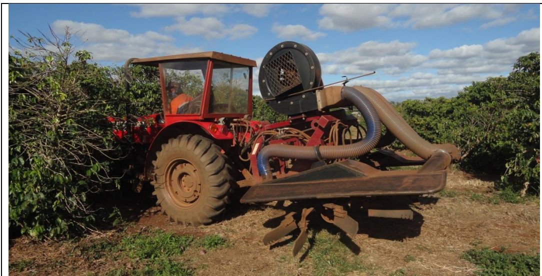
Equipamento do tipo “Varre tudo”, usado para esparramação do cisco em cafezal, tendo o ventilador desligado e a rotação do rastelo invertida.
