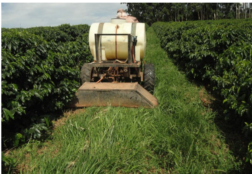
Vista de trás do triciclo operando com barra aplicadora de herbicida. No detalhe, pode-se observar a passagem bem rente aos cafeeiros e a barra bem próxima ao chão, com boa proteção, evitando deriva.
