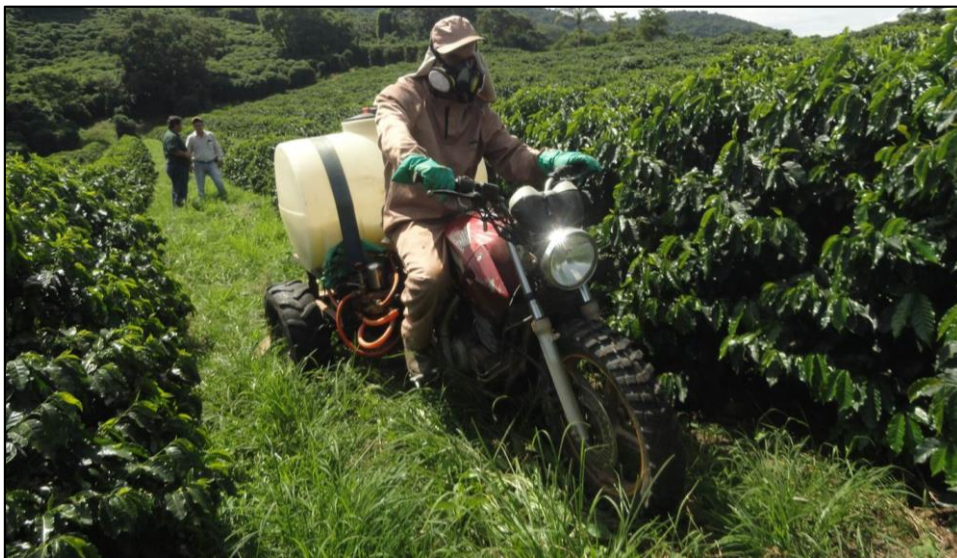
Triciclo operando na aplicação de herbicidas, vista de frente, o operador, por sua proximidade, tem boa visão do trabalho.
